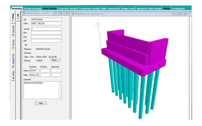
Picture 23 Edirne Sırpsındıgı Bridge abutment static modeling
